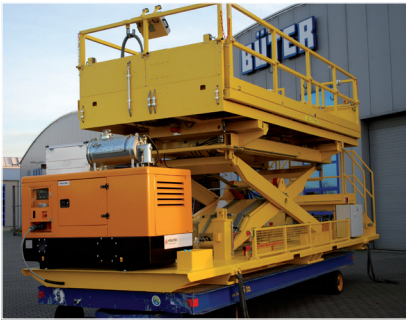
Büter AG Schweiz 30 kVA Stromerzeuger mit VERT-zertifiziertem Rußfilter im Sonderbau
