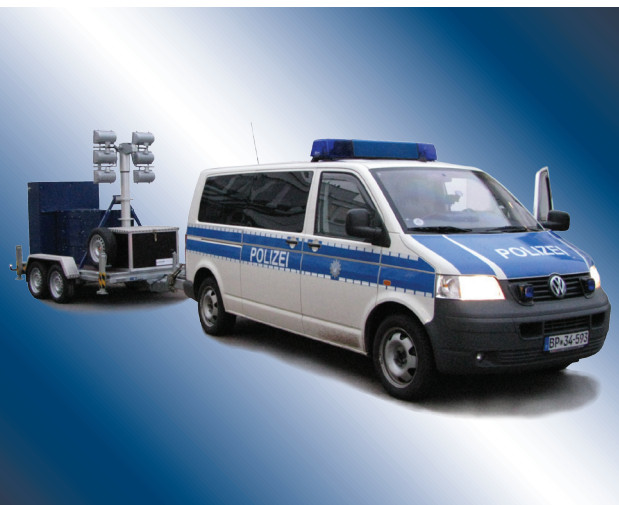
Bundespolizei Bundesrepublik Deutschland 7 Stück Lichtmasten-Aggregate fahrbar, 16 kVA, 9 Meter Pneumatik Lichtmast
