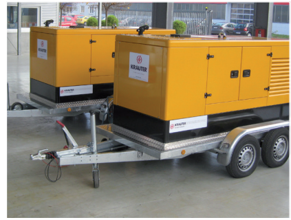
Wasserschiffahrtsamt Stuttgart 60 kVA Notstromaggregate auf TÜV-geprüften Fahrgestellen
