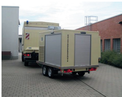
Katastrophenschutz Mecklenburg-Vorpommern 60 kVA Notstromaggregat in Schnelleinsatzfahrzeug mit Lichtmast
