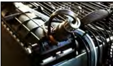
Kühlwasser-Niveau-Überwachung im Kühler
