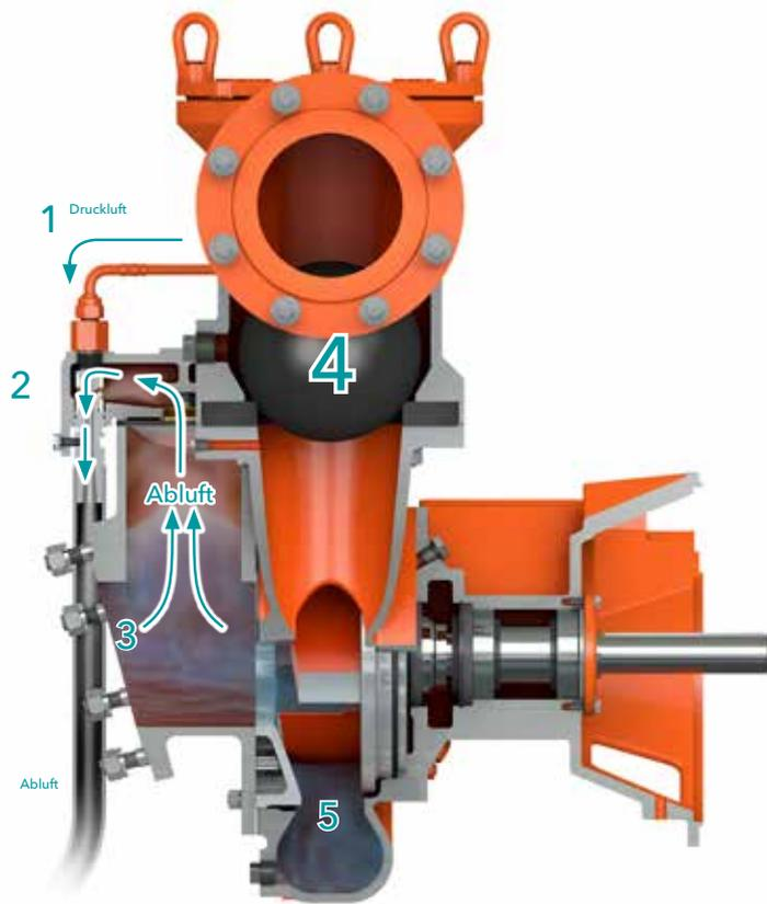
Automatisches Ansaugen bis zu 8,5 m Saughöhe ohne Bediener oder Fußventil. Die Godwin Dri-Prime-Pumpen der Serien CD und HL haben keine beweglichen mechanischen Teile in der Saugvorrichtung und saugen bei Trockenlauf immer wieder selbstständig an.
